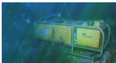
FRAME : Station sous-marine de Fond, Régionale, Autonome, de Mesure et d'Echantillonnage
