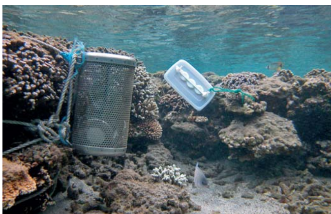
Échantillonneurs passifs sous l'eau : POCIS (cage en Inox) pour la mesure des composés organiques hydrophiles et DGT (capsules en plastique) pour la mesure des métaux traces. © Ifremer / Jean-Louis Gonzalez
