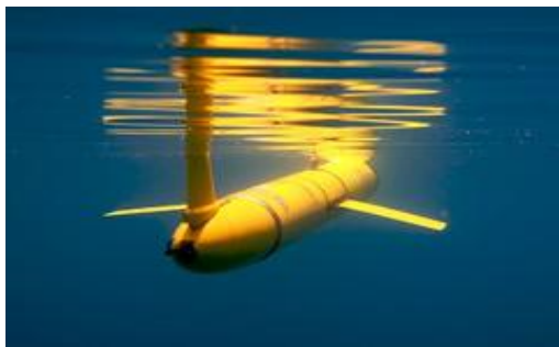
Le glider, planeur sous-marin autonome mis à disposition de la campagne par « Tara expédition » va permettre d'étudier les caractéristiques physicochimiques de la colonne d'eau.
