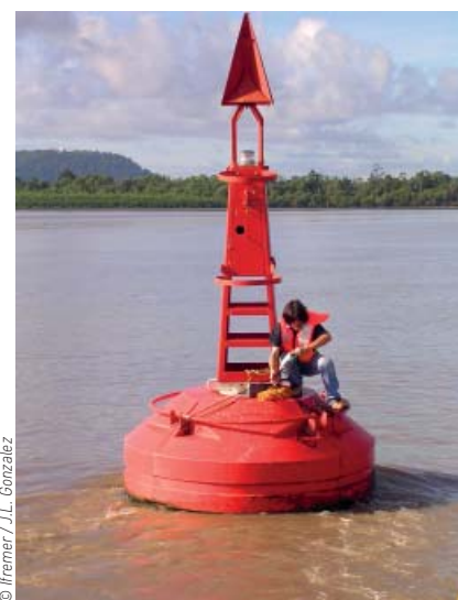
Mise en place d'échantillonneurs passifs pour la mesure de la contamination chimique
