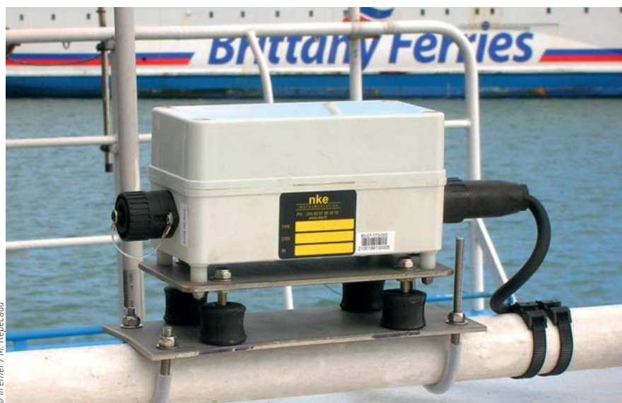
Ce concentrateur récupère les mesures, intègre la position du navire et transmet les données à terre
