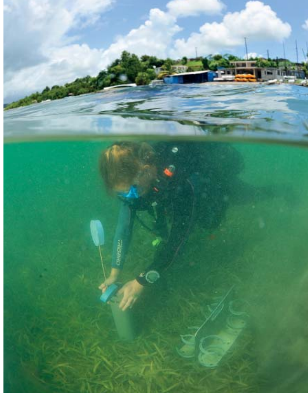
Carottages en plongée pour l'étude des faciès sédimentaires sous-marins de la baie du Robert en Martinique
