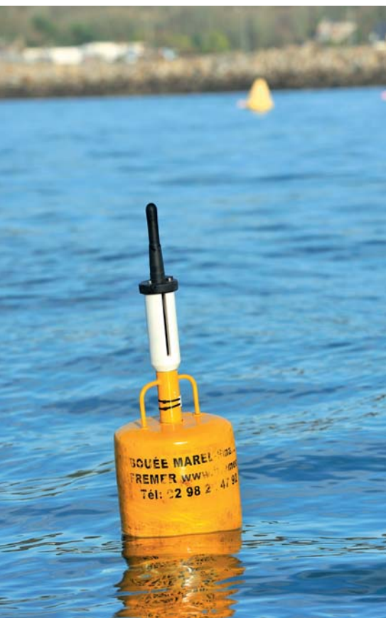
Bouée Smatch pour la mesure de la température et de la salinité
