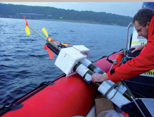
Essais du profileur Arvor équipé de la nouvelle transmission Argos3
