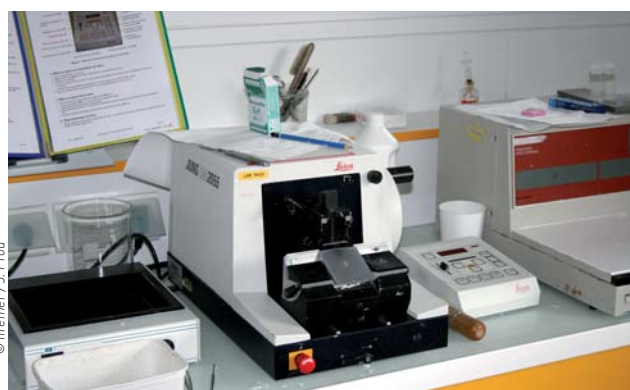
Microtome servant à la coupe des mollusques pour l'analyse histo-pathologique
