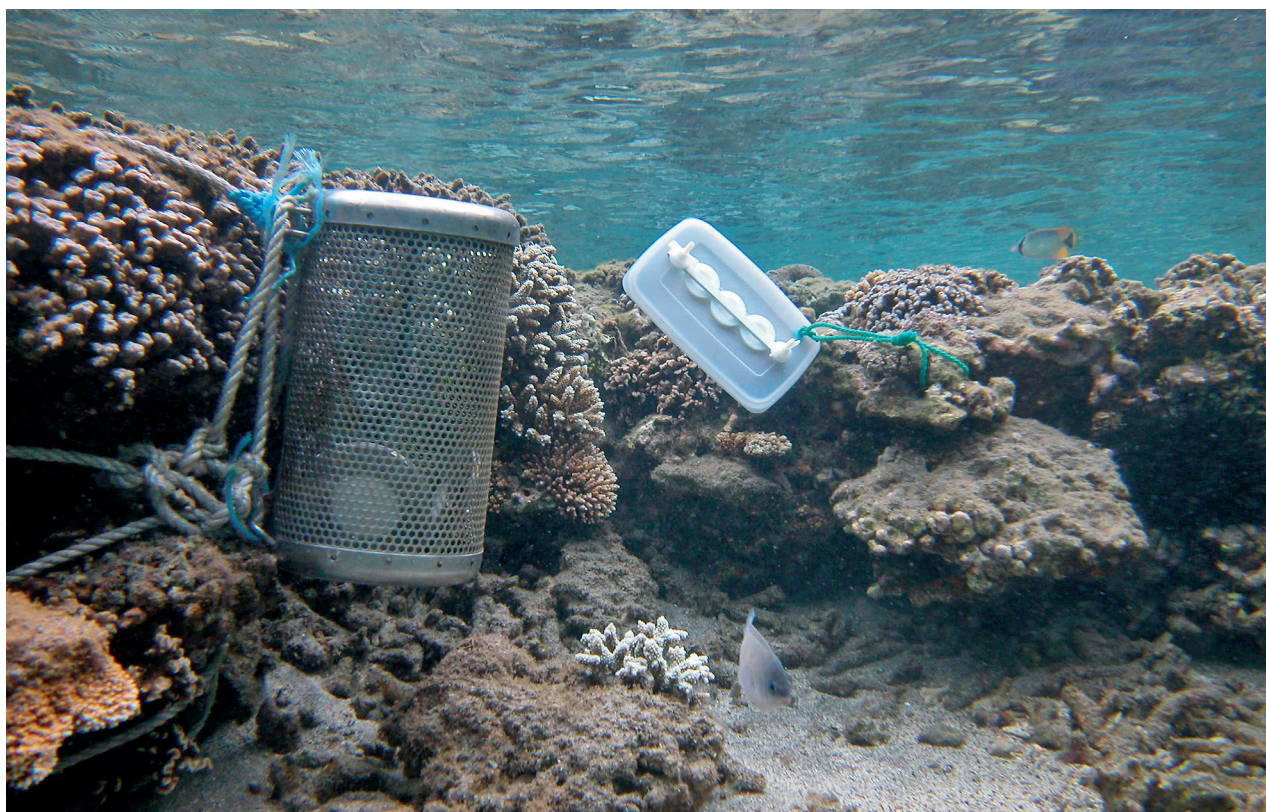
Echantillonneurs passifs sous l'eau : POCIS (cage en Inox) pour la mesure des composés organiques hydrophiles et DGT (capsules en plastique) pour la mesure des métaux traces.
