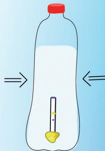
4 - Lorsque l'on appuie sur la bouteille, la pression fait descendre le stylo qui se remplit d'eau.
