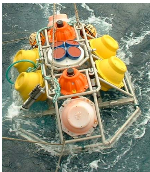
Type de mouillage pour la campagne ASPEX (d'après Koutsikopoulos et Le Cann)
