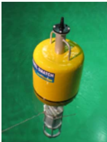
© Ifremer/Bassin d’essais de Boulogne-sur-Mer Stations de mesure de la qualité de l’eau en zone côtière (ici, la bouée miniaturisée « Marel Smatch »)
