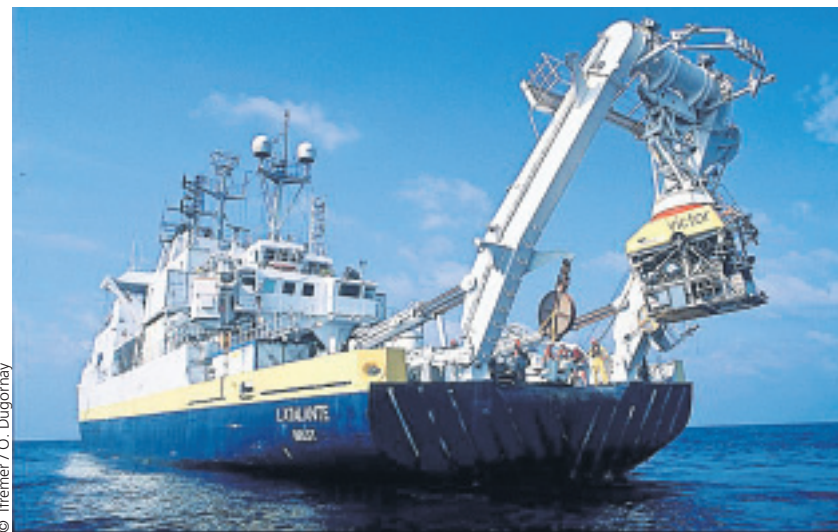
Mise à l'eau du ROV Victor 6000 à partir de L'Atalante, l'un des quatre navires qui composent la flotte hauturière de l'Ifremer.
